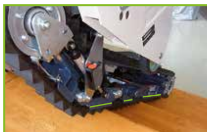
Easy and safe landing by flexible frame Einfaches und sicheres Befahren des Treppenpodestes durch einen flexiblen Rahmen
