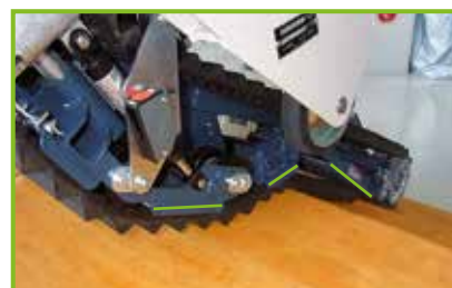
Easy and safe landing by flexible frame Einfaches und sicheres Befahren des Treppenpodestes durch einen flexiblen Rahmen
